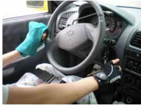
⑥ 좌측 손을 고정용 장갑(holding glove)으로 묶어 선회장치를 파지하고 우측 손으로 수동제어장치를 조작한다.
